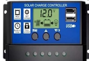
Figura 7 - Controlador de carga
