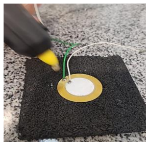
Figura 13 - Placa instalada na base maleável
