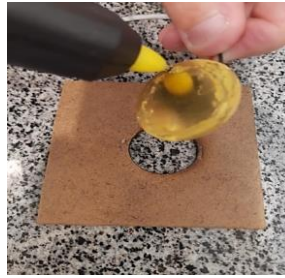
Figura 12 - Instalação da placa na base de madeira com furo
