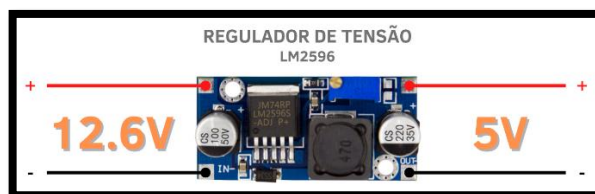
Figura 5 – Demonstrativo do regulador de tensão LM2596
