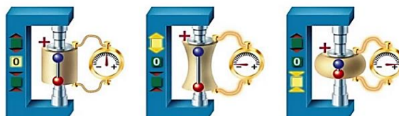
Figura 1 - Efeito piezoeletrico direto
