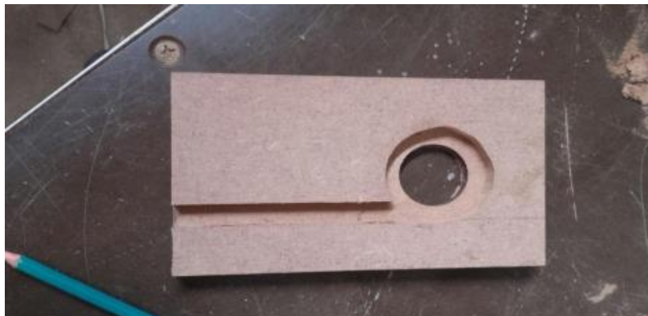
Figura 10 - Corte e furos na base
