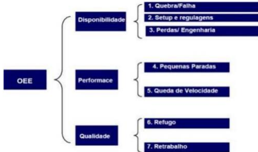
Figura 02: Elementos da Eficácia Global de uma Máquina
