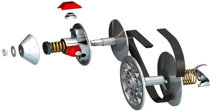
Figura 5 - Vista 3D das peças de uma CVT
