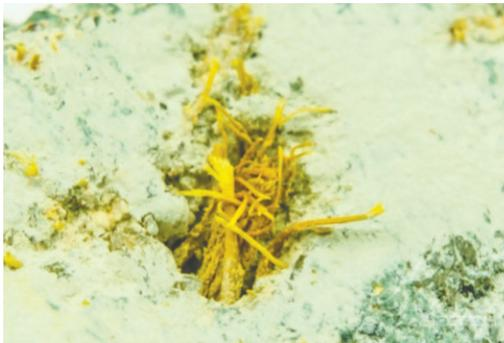
Figura 5 – Detalhe da baixa penetração de argamassa na trama de fibra de coco com resolução aumentada em 800x. Fonte: autores
