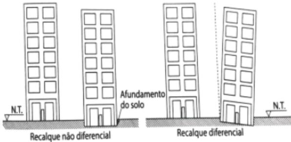
Figura 1 Recalque Diferencial. Fonte: BOTELHO, Manoel Henrique Campos. Princípios da Mecânica dos solos e Fundações para a Construção Civil. Editora Bluncher, 2015.
