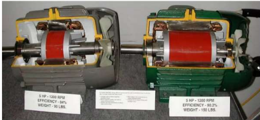
Figura 3: Comparativo de dimensões entre um motor convencional e um motor de alto rendimento
