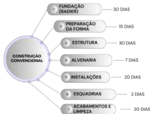
Figura 6 - Fluxograma construção convencional
