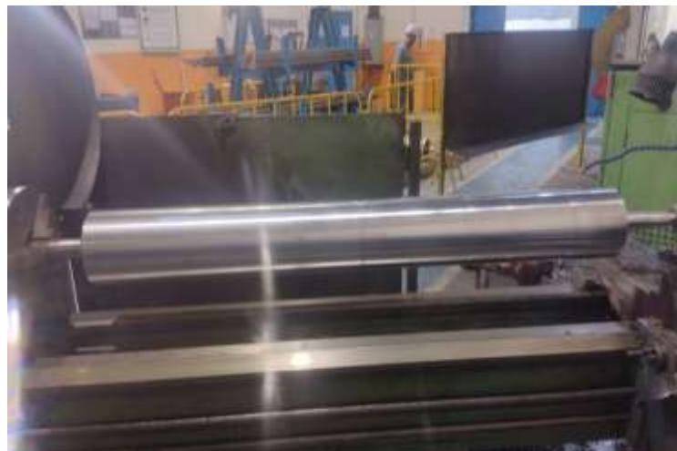
Figura 4- Rolo da mesa finalizado a extensão.
