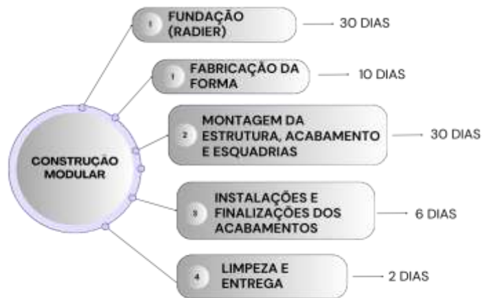
Figura 5 - Fluxograma construção modular
