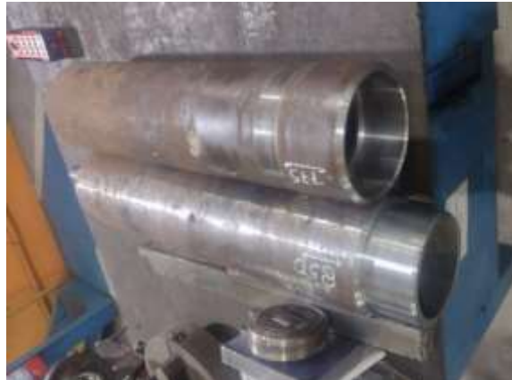
Figura 2- Rolo em processo de usinagem
