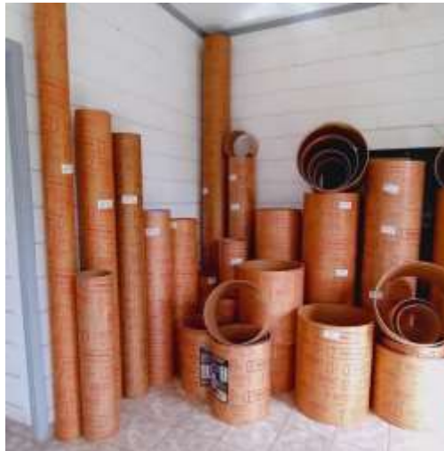
Figura 1: Formas de tubos de papelão empregados na construção civil
