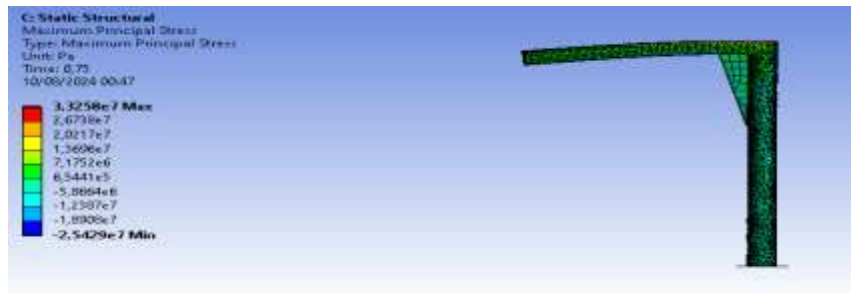
Figura 8: Simulação em elementos finitos, realizada no programa ANSYS
