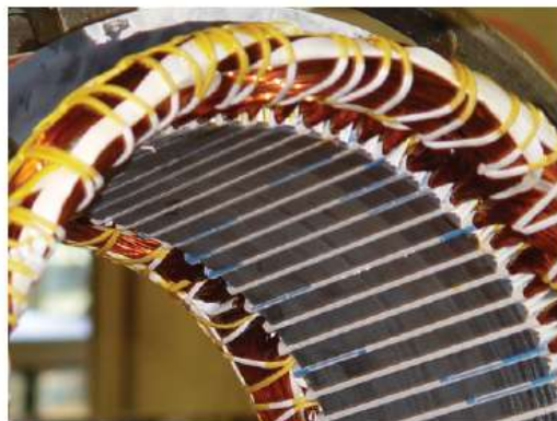
Figura 5: Fios condutores e laminados em um estator
