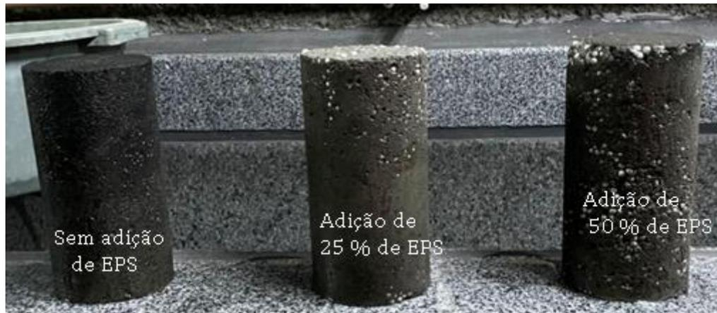
Figura 01 – Corpos de prova sem adição de EPS e com adições de EPS (25% e 50%)
