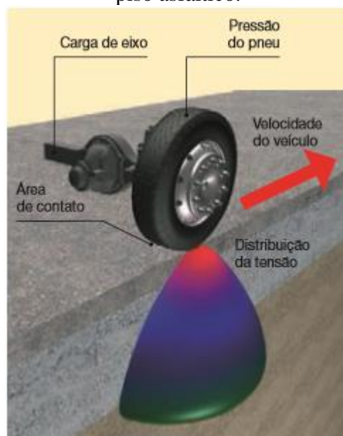
Figura 3 – Efeito da distribuição da força peso da carga transportada em caminhão sobre o piso asfáltico.
